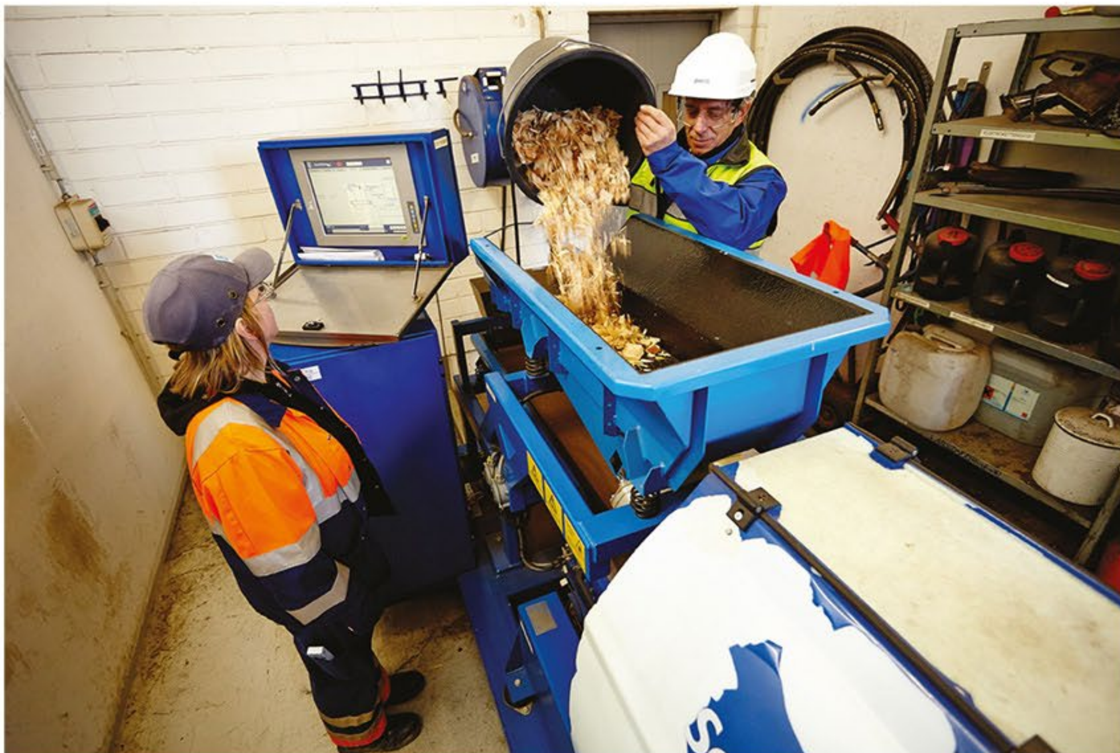
O ScanChip é uma tecnologia avançada de monitoramento que avalia a qualidade dos cavacos de madeira em tempo real e permite ajustes imediatos no processo, garantindo uma matéria-prima uniforme e de alta qualidade
